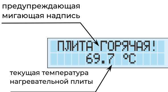
Рис. 9.2 Индикация предупреждения о высокой температуре плиты
